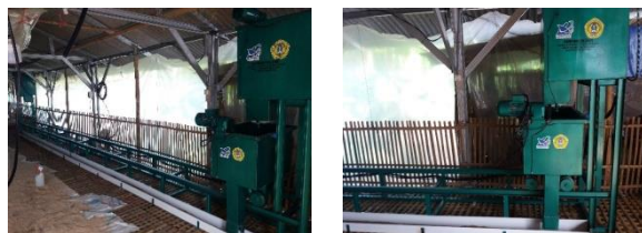
Gambar 4. Mesin pakan ayam otomatis berbasis Internet of Things (IoT) pada UKM mitra
